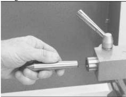
Insertion de la pointe fixe dans le fourreau de la contre-pointe
