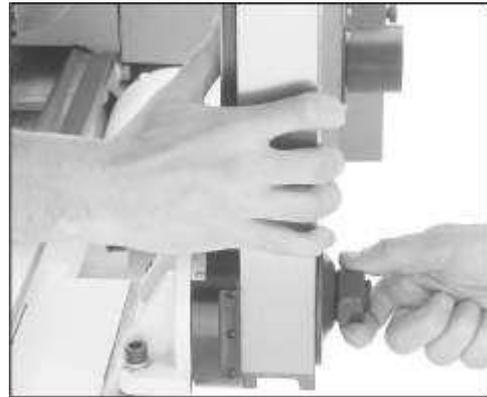
4. Faites coïncider le « 0 » du verrier angulaire avec le repère du bâti avant de bloquer l'écrou de blocage
