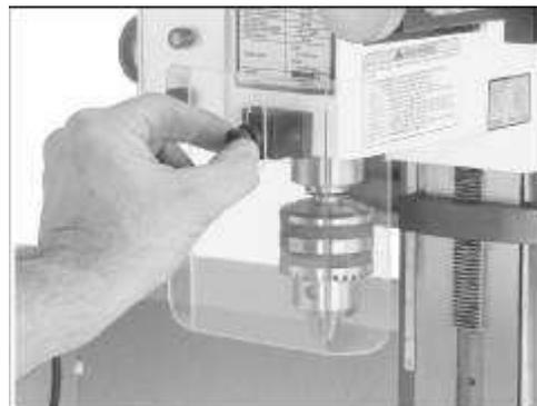
**Figure 3.** Fixer l'écran sur la tête de fraisage/perçage.
