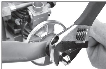
1. Retirer l'écrou d'hélice et la rondelle d'hélice du vilebrequin.
