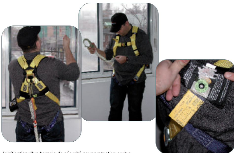
L'utilisation d'un harnais de sécurité pour protection contre les chutes de hauteur est recommandée dans plusieurs situations de travail en hauteur. Son efficacité dépend de plusieurs éléments que l'on doit considérer attentivement, dont sa conformité à la norme CSA Z259.10 Harnais de sécurité. Il doit porter une étiquette indiquant cette conformité.
