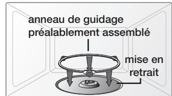
4. Déposez le « plateau en verre » sur « l'anneau », en veillant à le positionner correctement.
