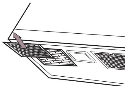
6. Laissez tremper le filtre dans un détergent doux dilué dans de l'eau chaude. Rincez-le et secouez-le pour le sécher. Brossez doucement le filtre pour retirer les saletés incrustées.
