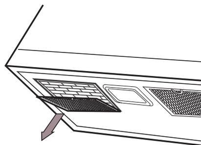
4. Retirez le filtre à graisse du panneau inférieur.
