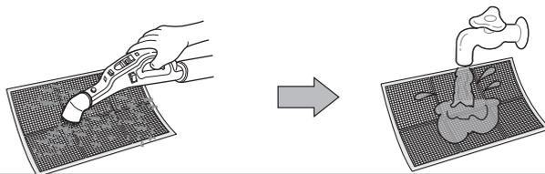
3. Nettoyer le filtre à air à l'aide d'un aspirateur ou d'un pinceau doux. S'il y a trop de poussière, le passer sous l'eau et le faire sécher dans un endroit ventilé.
