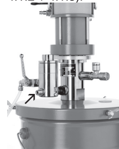
Image 4.1.2 Raccord pour tuyau de produit au filtre haute pression
