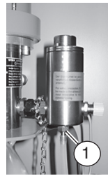
Image 4.2.4 Filtre haute pression avec vis de vidange
