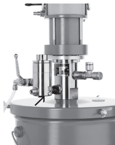
Image 2.4.1 Vis de mise à la terre du filtre à haute pression
