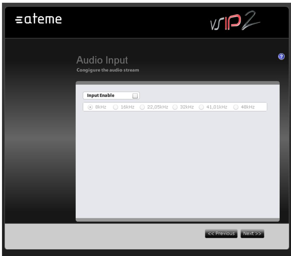
Quand la case "Enable AAC" est active, vous avez la possibilité de spécifier la fréquence d'échantillonnage de l'audio. Le débit numérique dépend de la fréquence d'échantillonnage suivant la table ci-dessous :
