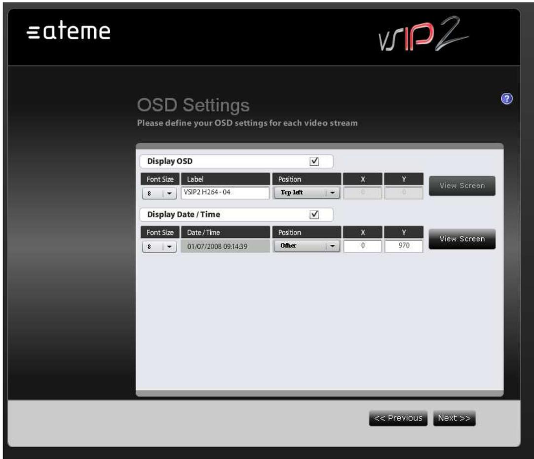
L'utilisateur peut définir et configurer l'affichage écran (OSD) pour le canal d'entrée vidéo. Cette fonctionnalité permet à la vidéo d'être aisément identifiée et offre la possibilité d'inclure la date et l'heure sur le flux transmis. L'utilisateur a la possibilité de définir n'importe quel texte et de le placer à l'endroit de son choix dans l'affichage.
