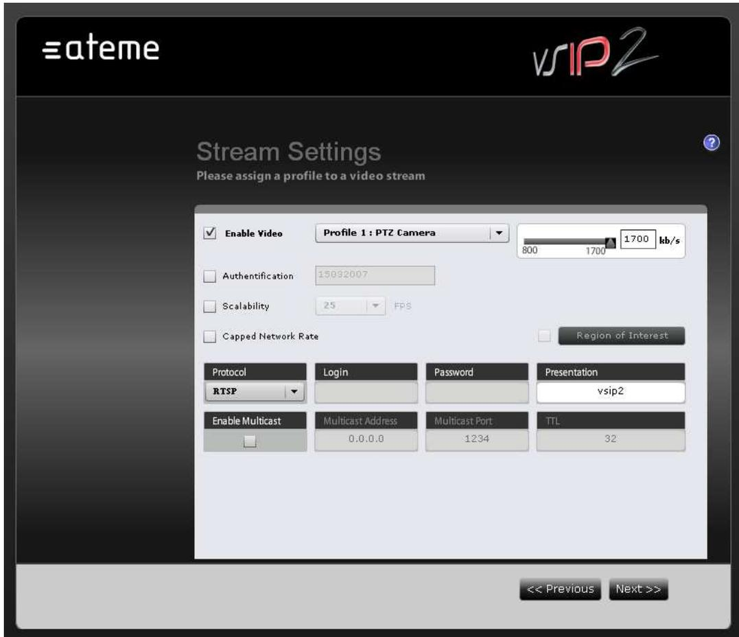
A la droite du profil sélectionné, l'utilisateur a la possibilité d'ajuster le débit numérique. Le débit numérique est la mesure du nombre de bits transmis dans un intervalle de temps donné. Il s'agit en général du nombre de bits par seconde.
