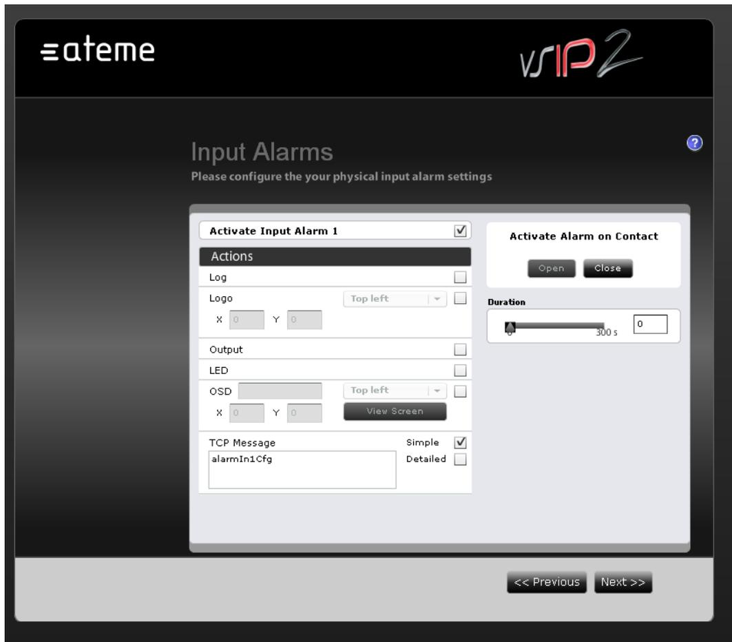
Pour utiliser l'entrée alarme, l'utilisateur devra connecter une source de courant aux entrées P(+) et N(-) de la section "Alarme in" à l'arrière du VSIP2.
