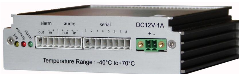
Le diagramme suivant est une représentation des connecteurs de la face arrière du VSIP2
