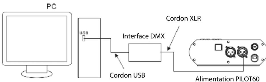
L'interface doit être connectée au PC grâce au cordon USB.
