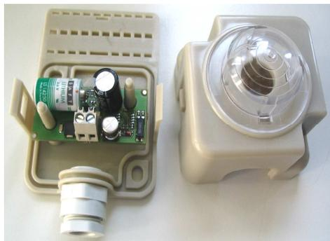
Passer les 2 fils de raccordement dans le presse étoupe et les raccorder dans les bornes à vis à l'aide d'un tournevis à tête plate.
