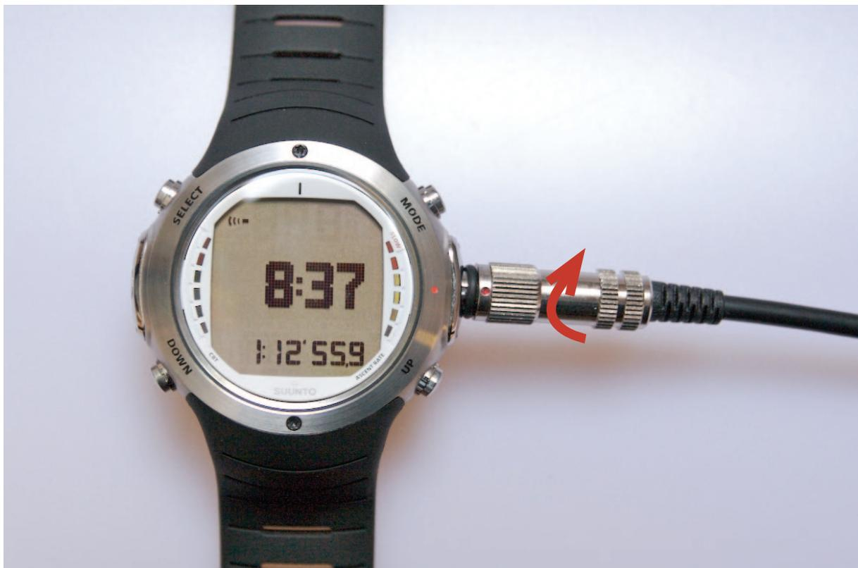
4.1 Placez le connecteur au niveau du point rouge et faites-le tourner dans le sens des aiguilles d'une montre.
