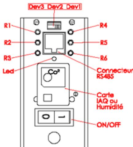
Figure 3: Interface de contrôle
