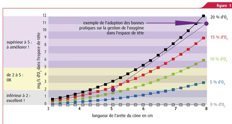
Oxygène gazeux contenu dans le BIB à la mise en fonction de la concentration en oxygène dans l'espace de tête et la longueur de l'arête du cône. Exemple de l'impact de bonnes pratiques de remplissage sur la réduction de l'oxygène du cône d'air.
