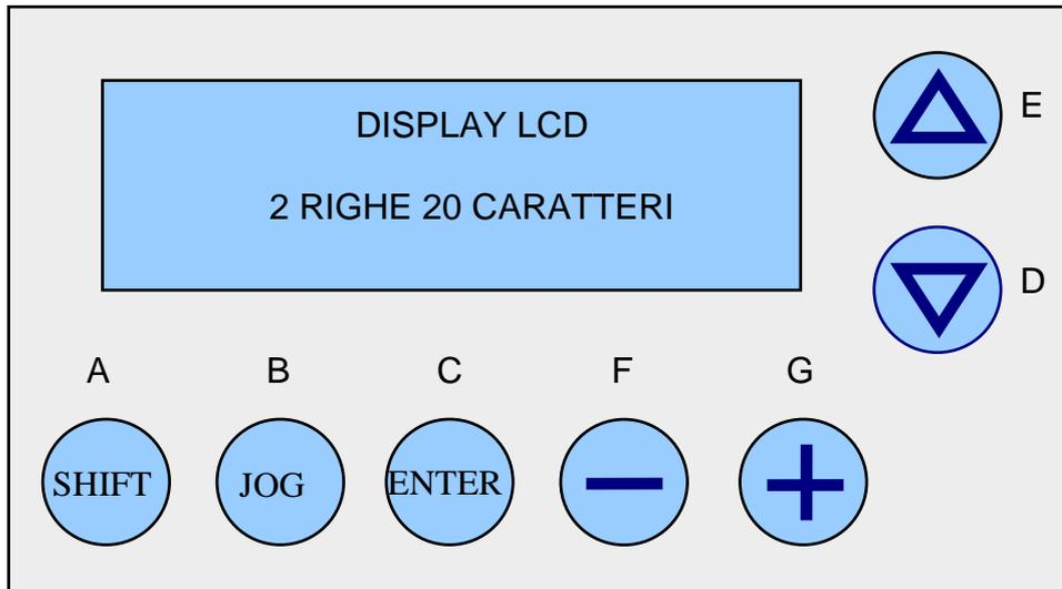
Il est composé par un display à cristaux liquides de 2 lignes de 20 caractères chacune et par un ensemble de 7 touches (4 de direction et 3 de fonction) ayant le sens suivant :
