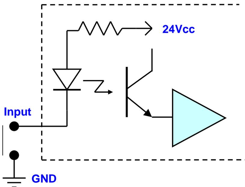
Toutes les entrées sont optoisolées, et peuvent être connectées directement à des sorties du type open collector NPN. Pour activer une entrée il faut la brancher sur GND.
