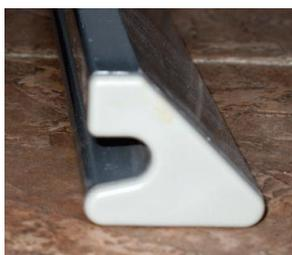
7- Dégonflez les boudins pour installer les barres latérales dans les emplacements prévus. La partie en biseau est appuyée au boudin, le côté plat étant au fond. Le plancher rentre dans l'encoche en soulevant, au moyen de la sangle, le plancher. Vous pouvez aussi insérer une rame pour le soulever légèrement. La première fois, vous risquez de forcer un peu pour mettre en place ces 2 barres.
