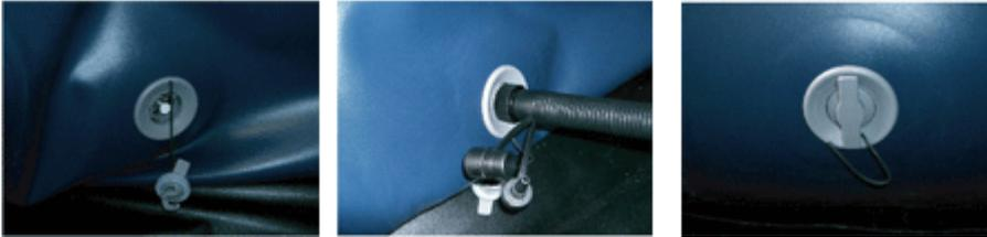
Pour dégonfler le bateau, appuyez sur le piston et tournez dans le sens des aiguilles d'une montre pour l'enfoncer.
