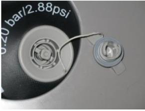
Les pneumatiques Charles Oversea sont pourvus de valves de gonflage anti-retour pour éviter que l'air ne s'échappe lorsque l'on retire le tuyau du gonfleur ou lorsque l'on dévisse accidentellement le bouchon de la valve.
