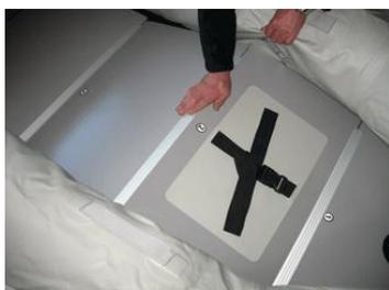
6- Le dernier panneau doit être mis en force (légèrement). Les plaques doivent être soulevées puis enfoncées pour que l'ensemble du plancher trouve naturellement son emplacement.
