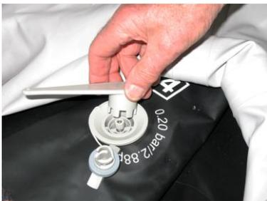
Vous pourrez être amené à démonter ou changer les valves bien que cette opération ne soit pas conseillée. Vous trouverez dans le kit de réparation une « clé » en plastique. Utilisez-la pour dévisser la valve en prenant soin de tenir la partie à l'intérieur du boudin. Pour la remise en place, enduire les 2 joints noirs d'huile ou de vaseline pour obtenir une étanchéité parfaite. La valve ne doit pas être serrée à fond. Faites des essais pour vérifier que l'air ne s'échappe pas.
