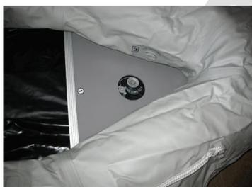
2- Installer au fond du bateau le plancher n°1 (avant du bateau).
