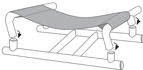
montants vers le haut. Placez ensuite (mais n'insérez pas) les quatre petits montants de la plateforme du siège sur le dessus des montants du cadre du siège tel qu'illustré.
