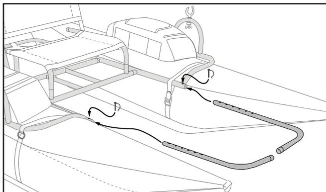
Attachez les sangles à l'armature du ponton en les faisant passer par l'anneau carré et en les fixant à l'aide du crochet des sangles de la boucle. Vous devrez éventuellement effectuer des réglages pour centrer la plate-forme en tissu sur l'armature.
