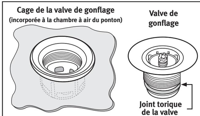
La valve de gonflage comporte deux parties. La valve de gonflage et la cage de la valve. La cage de la valve de gonflage protège la valve et est incorporée à la chambre à air du ponton.
