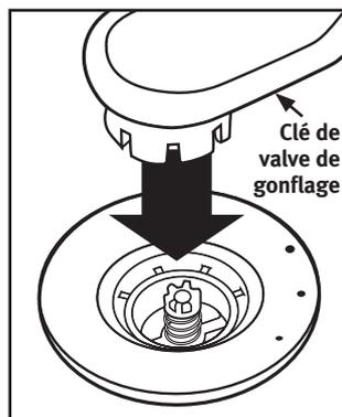
à air du ponton) afin de plus facilement tourner la valve. Faites attention à ne pas déchirer la chambre à air.
