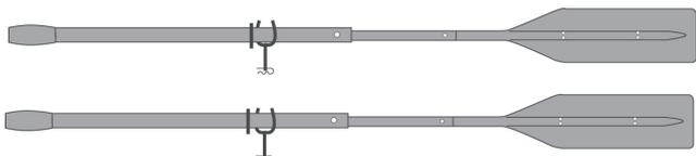
Retirez ensuite les goupilles des tolets fixés à la partie supérieure des rames et faites glisser les tolets dans les supports situés sur l'armature. Réglez ensuite la butée de rame en caoutchouc de manière équilibrée sur les deux rames afin de pouvoir ramer de manière optimale.
