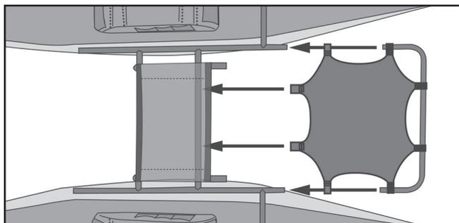
Commencez par insérer la partie avant de l'armature de la plate-forme de chargement dans les armatures du ponton. Insérez un axe d'épaulement court de chaque côté de l'armature, de haut en bas, dans les trous où l'armature de la plate-forme de chargement s'encastre dans les armatures du ponton.
