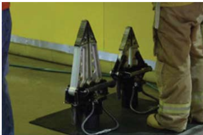
Figure 3-10. Outils de désincarcération (ou mâchoires de survie), le gros à gauche et le petit à droite, utilisés pendant le test de transport de matériel de désincarcération.
