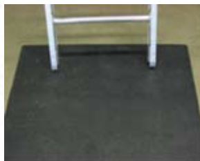
Figure H-8. Base de l'échelle appuyée sur un tapis antidérapant. Tout en permettant d'assurer l'échelle, ce montage permet aussi à l'aspirant de savoir exactement où il doit mettre les pieds. Des instructions telles que « Au début et à la fin de chaque répétition, vous devez placer vos pieds sur le tapis noir », sont simples, faciles à comprendre et faciles à retenir.
