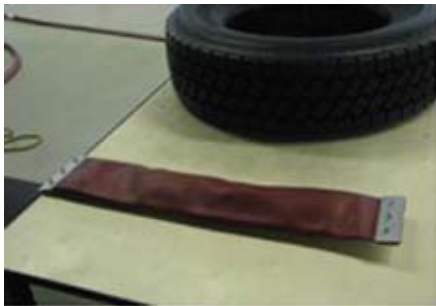
Figure H-4. Vue du pneu de camion sur une table lisse. La figure montre aussi un poids fait d'un bout de tuyau rempli de morceaux de plomb. Il est à remarquer que les extrémités du tuyau sont fermées à l'aide de pinces. Il est essentiel d'empêcher les fuites du « lest » (c.-à-d. les morceaux de plomb ou le sable). Même s'il est enveloppé dans du plastique et scellé à l'aide de ruban pour canalisations, un sac de sable se déchirera et se videra de son contenu.
