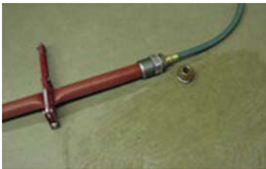
Figure H-1. Montage pour la mise sous pression d'un tuyau d'incendie à l'aide d'un tuyau d'arrosage. L'eau provient d'un robinet d'arrosage (ou du robinet d'une cuve de lavage) raccordé à un tuyau d'arrosage (de jardin). Le raccord est confectionné à l'aide de pièces de robinetterie vendues chez tout détaillant d'accessoires de plomberie. L'emploi de ruban Téflon sur tous les raccords et colliers de serrage aide à prévenir les fuites.
