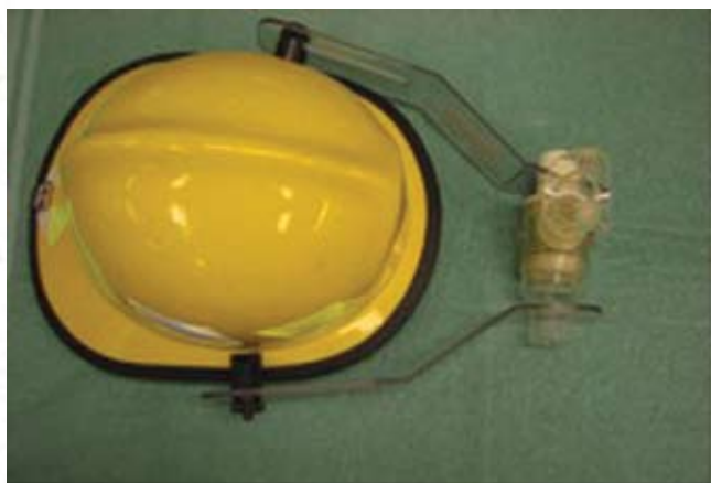
Figure 3. Casque modifié avec supports latéraux pour valve respiratoire Hans Rudolph.
