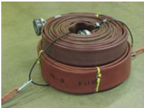
Figure H-3. Montage de l'ensemble de tuyaux servant au test de traction du tuyau à grand débit. Il est à remarquer que les tuyaux de 100 mm et de 65 mm de diamètre sont attachés séparément, puis retenus ensemble au moyen d'un câble à guipage plastifié. Des mousquetons retiennent les deux cordes à l'ensemble de tuyaux.
