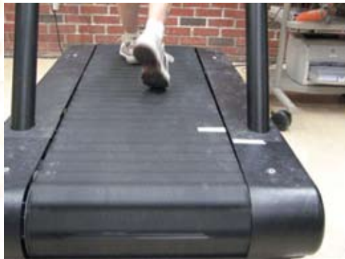
Figure G-2. La vérification de la vitesse du tapis roulant nécessite un chronométrage précis du nombre de tours qu'effectue le tapis en un temps donné. Il faut remarquer le moment où le repère en ruban sur le tapis s'approche du repère sur le cadre du tapis roulant. Chaque fois que le ruban passe vis-à-vis du repère sur le cadre, le tapis a fait un tour complet. Consultez le texte pour plus de détails. Il est essentiel qu'une personne marche sur le tapis pendant la vérification de sa vitesse.
