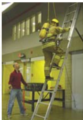
Figure H-7. Montage pour le test de la montée dans l'échelle.
