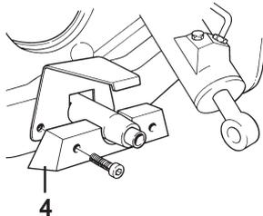
**⚠ AVERTISSEMENT !** Risque de pénétration d'eau. Contrôler soigneusement que le capteur d'assiette est bien tenu par la plaque support avant de mettre en place l'anode et de serrer les vis.
