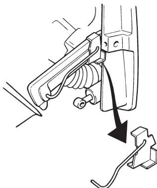
La transmission ne peut être relevée à la main en position haute maximum. Maintenir la transmission prête dans cette position et mettre en place l'outil côté tribord conformément à la figure. Vérifier soigneusement l'état des soufflets. Les soufflets d'échappement peuvent être remplacés sans enlever la transmission.
