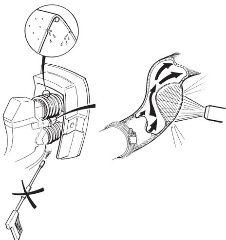
**⚠ IMPORTANT !** Il convient d'être prudent si le nettoyage est effectué au moyen d'un jet d'eau à haute pression. Ne pas diriger le jet sur les soufflets de raccordement de l'échappement et de l'embase, les joints d'étanchéité du vérin de réglage d'assiette, le joint d'étanchéité de l'arbre d'hélice, les tuyaux flexibles, etc.
