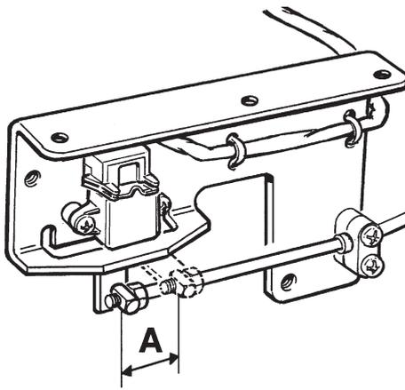
Support des potentiomètres lors de l'utilisation de commandes mécaniques
