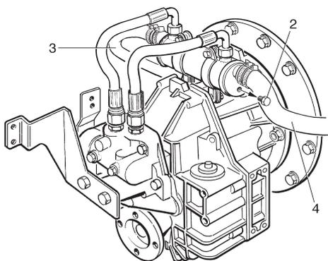
**1. Moteur avec transmission :** Enlever le tuyau flexible de prise d'eau de mer du capot et fermer l'entrée par un bouchon (1) rendu étanche par un collier de serrage. L'eau rentre immédiatement lorsqu'on enlève le tuyau flexible de prise d'eau de mer. Avoir à portée de main les outils, le bouchon et le collier de serrage. Plier le tuyau flexible de prise d'eau de mer vers le bas pour laisser s'écouler l'eau.
