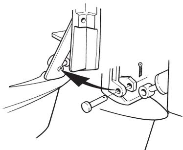
**⚠ AVERTISSEMENT !** Ne jamais intervenir sur les soufflets de l'embase ou le circuit hydraulique sans avoir calé l'embase en position relevée maximale, de façon à ce qu'elle ne puisse pas retomber. En retombant, l'embase peut provoquer des blessures graves.
