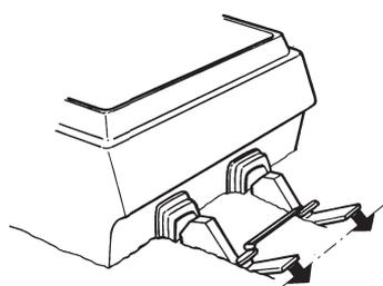
Lors du relèvement simultané, l'embase doit d'abord être amenée dans sa position la plus avancée (0). Commencer à les relever à partir de cette position.
