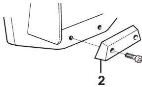
Desserrer les deux vis qui tiennent l'anode (2). Enlever l'anode et la plaque support sous l'anode. Nettoyer la surface de contact. Remettre en place la plaque support avec l'anode neuve.
