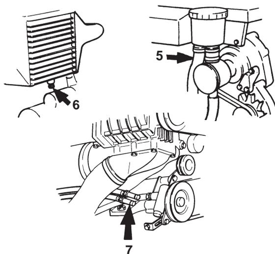
2. Débrancher le tuyau flexible (5) et purger l'échangeur de chaleur. Purger le radiateur de refroidissement de l'air d'admission (CAC) en ouvrant le bouchon (6) et le radiateur d'huile en ouvrant le bouchon sur le tuyau flexible marqué en bleu (7).
