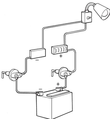
4. Un coupe-batterie doit être branché sur la borne positive (+) de la batterie. Le coupe-batterie doit isoler tous les équipements qui consomment du courant lorsque le bateau n'est pas utilisé.
