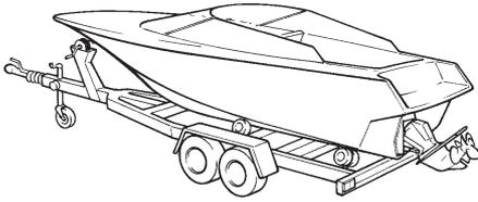
**⚠ IMPORTANT !** Le moteur ne doit pas tourner lorsque la transmission est relevée au maximum. Avant de transporter le bateau sur une remorque, immobiliser la transmission en position haute maximale à l'aide d'un kit de remorquage (accessoire) ou similaire, pour éviter qu'elle retombe.
