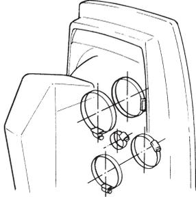
**DP, DPX :** Les vis du collier de serrage doivent être positionnées conformément à la figure lors du serrage.
