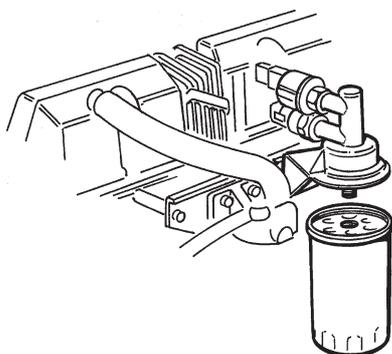
Desserrer le filtre usagé. (Pour éviter que l'huile ne gicle, placer un sac plastique autour du filtre avant de le desserrer). S'assurer que la surface de contact sur le moteur est propre et que le joint d'étanchéité en caoutchouc usagé a été enlevé.
