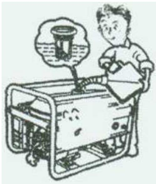
Remplissez le carburant jusqu'à la marque supérieure du filtre à carburant.
