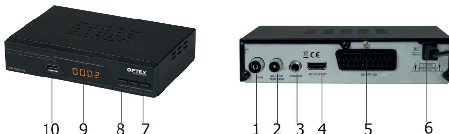
**1. Connexion de l'antenne** : Insérez le câble en provenance de votre antenne dans le connecteur indiqué sur le schéma ci-dessus.
