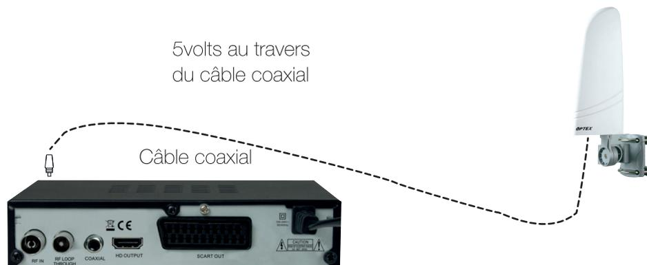
**PS :** Pour cela, activer cette fonction «**Alimentation 5volts**» au travers du câble coaxial, il suffit de sélectionner l'option **MARCHE** dans le menu **Recherche/Alimentation antenne**.
