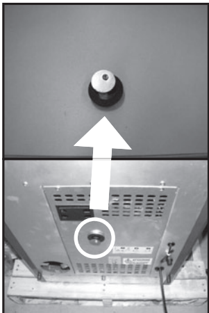
Illustration 6 : vue arrière du poêle. Vanne papillon montée sur l'entrée d'air de combustion.
