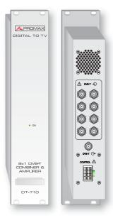
Le DT-710 est un coupleur de 8 entrées et une sortie conçu pour combiner les signaux RF de sortie des modulateur et transmodulateurs de COFDM, avec les canaux TNT disponibles dans la région. Le système fournit une sortie amplifiée de 114 dBuV (+6dBm), souvent nécessaire pour les systèmes SMATV.
