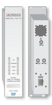
Les modules **DT-101** (simple) et **DT-102** (double) sont des modulateurs COFDM compatibles avec le standard DVB-T (TNT). Ils possèdent entrée TS-ASI et sortie RF en bande UHF. La fréquence et le niveau de sortie sont réglables par l'installateur. Les entrées peuvent contenir des programmes de tout type de formats : SD, HD, MPEG-2, MPEG-4, etc.
