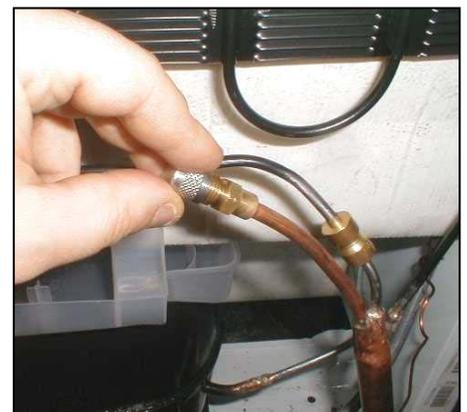
10d) Technique d'utilisation de la station pour la réalisation du vide uniquement dans la section basse pression du circuit.
