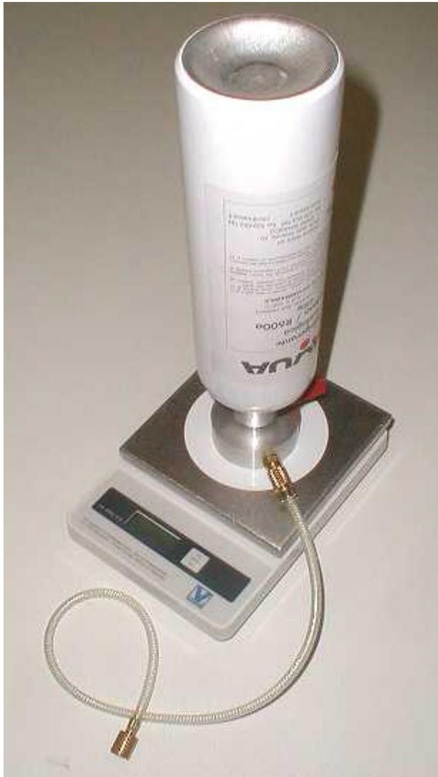
L'isobutane ne peut pas être utilisé en colonne de charge comme pour le gaz R12 ou R134a ; ce gaz est donc chargé selon le principe de la "pesée".
