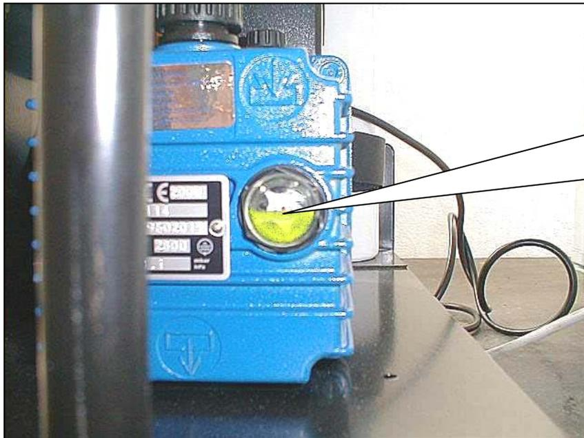
Niveau maximum de l'huile lubrifiante de la pompe à vide, lisible à travers le hublot transparent.
