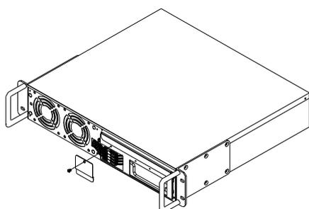
3. Enlever les deux vis de retenue et les connecteurs des câbles.
