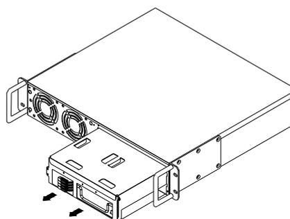
6. Mettre les nouveaux blocs batteries dans le logement. Serrer les vis et remettre en place le capot de protection du câble et le panneau avant. Recharger l'unité pendant au moins 8 heures pour s'assurer que l'onduleur fonctionne avec l'autonomie attendue.
