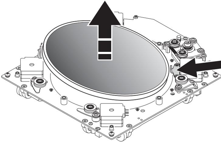
10 Placez la nouvelle lentille en place sur le châssis J en prenant garde de ne pas toucher à la butée de rotation (repère fléché sur le dessin ci-dessous).
