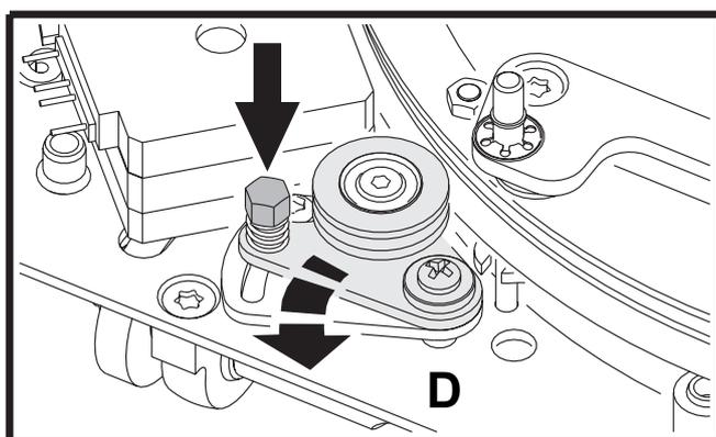
6 Dégagez les galets F en appuyant sur le ressort de tension
