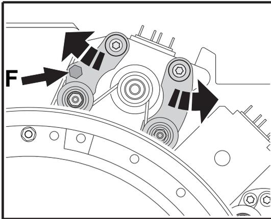
7 Tirez vers l'extérieur le crochet C (sur ressort) et dégagez tout le berceau I du châssis de lentille J en prenant garde d'éviter le capteur de position E et sans endommager la courroie des galets F, G et H.
