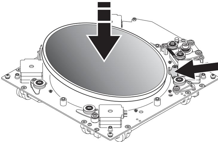
**Note** *Si vous installez la lentille diffuseur standard, la face texturée doit faire face à la lampe et au module de rotation.*
