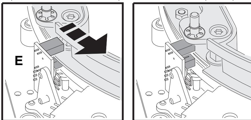
5 Dégagez le galet D en appuyant sur l'écrou maintenant le ressort de tension.
