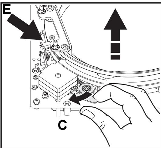
8 La lentille est maintenue sur son châssis J par 4 lames. Pour libérer chaque lame, poussez sur les ressorts de tension par la face inférieure du châssis comme illustré ci-dessous. Les ressorts maintiennent les lames en place contre la lentille.
