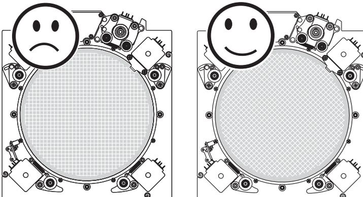
La lentille doit être en appui sur les quatre blocs de caoutchouc repérés sur le dessin ci-dessous..
