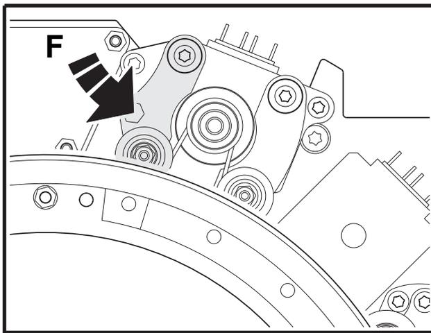
18 Faites tourner le berceau plusieurs fois d'une butée à l'autre pour vérifier qu'il tourne sans problème et sans accrocher. Si ce n'est pas le cas, le berceau est probablement mal placé. Retirez-le et recommencez la procédure.
