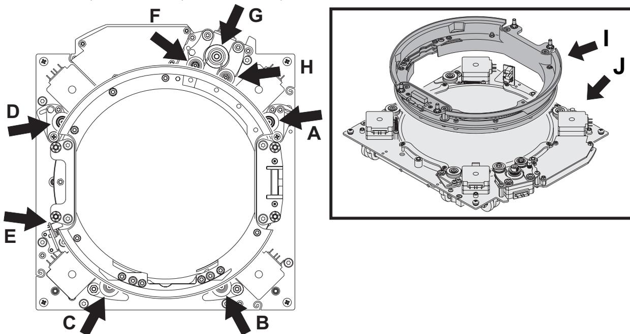
4 Déplacez le berceau rotatif I vers une position où il est libéré du capteur de position E.
