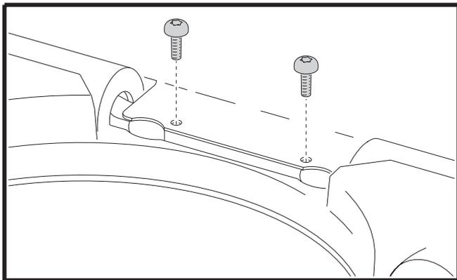
21 Remontez le système de volets sur le MAC 2000 Wash en suivant les instructions de la section “Montage et utilisation du système de volets asservis” en page 4.
