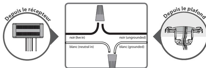
5. Pour éviter tout risque d'électrocution, **UTILISEZ LES CAPUCHONS DE CONNEXION POUR ISOLER LES FILS APPARENTS PROVENANT DU PLAFOND** avant de rétablir le courant.
