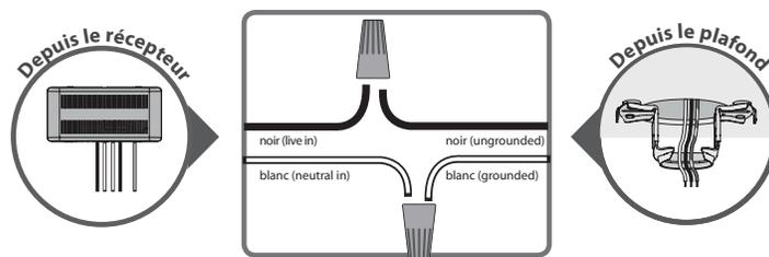
3. Pour éviter tout risque d'électrocution, **UTILISEZ LES CAPUCHONS DE CONNEXION POUR ISOLER LES FILS APPARENTS PROVENANT DU PLAFOND** avant de rétablir le courant.
