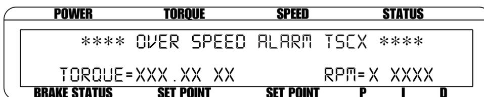
Figure 6–9 Message d’alarme lors d’un surrégime (Over Speed Alarm)
