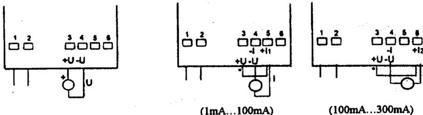
\*) Pour la mesure de courant, l'utilisateur doit relier les bornes 3 (+U) et 5 (I+) ou 3 (+U) et 6 (+I2)
