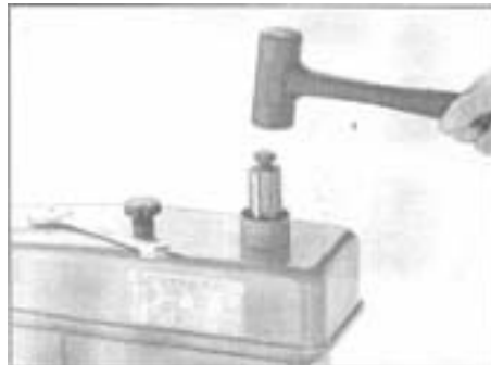
Schéma 12. Démontage du mandrin de perçage
