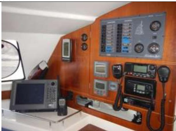
Chart GPS plotter avec radar et mobile VHF & Instruments avec GMDSS-VHF et panneau électrique
