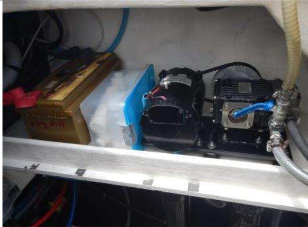
Batterie du démarreur et pompe de haute pression pour le système d'eau douce par l'osmose inverse
