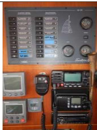
panneau électrique & instruments dans le salon avec GMDSS-VHF et transmetteur de réserve avec antenne intérieure
