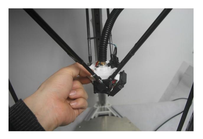
IV. Resserrer si besoin la courroie à l'aide de la vis afin de la tendre suffisamment pour avoir une impression optimum. Important veiller à ne pas trop la serre non plus, sinon elle risque de s'user plus rapidement.
