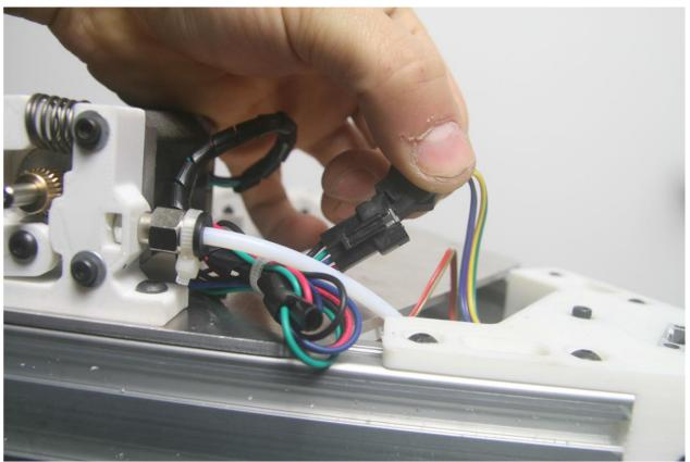
VI. Installer la fiche du câble LCD et le serrer avec la vis.
