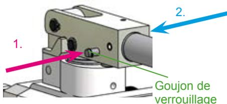
Déverrouillez (1.) : le système de blocage pendant le transport de la pompe en glissant le goujon de verrouillage jusqu'à la butée en direction du volant.
