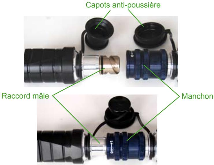
Avant le couplage, enlever les capots anti-poussière puis brancher le raccord mâle et le manchon ensemble et tourner la douille de verrouillage du raccord mâle dans le sens « 1 » jusqu'à ce qu'elle s'enclenche. La liaison est maintenant établie et bloquée. Le découplage se fait en tournant la douille de verrouillage dans le sens « 0 ».
