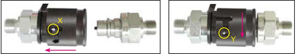
Avant le couplage, retirer les capots anti-poussière puis tirer et maintenir la douille de verrouillage du manchon (position X). Brancher le raccord mâle et le manchon ensemble et relâcher la douille de verrouillage. Tourner ensuite la douille de verrouillage en position Y. La liaison est maintenant établie et bloquée. Le découplage se fait dans l'ordre inverse.
