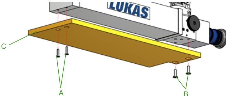
2. Enlever la plaque de base C et la remplacer par une nouvelle.
