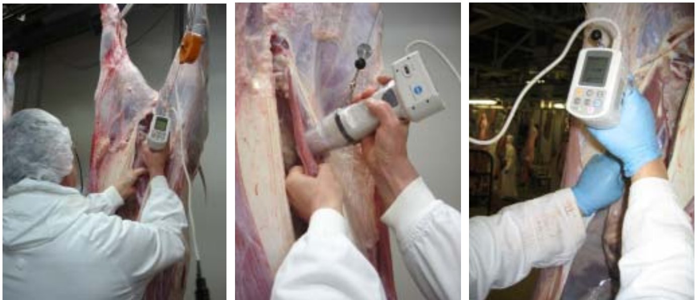
Photos 15, 16 & 17 : Prise de mesure avec le CR-410
