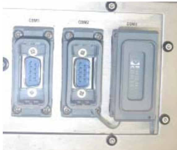
Ports séries du Panel PC se situant en bas à droite de la face arrière
