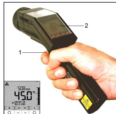
Le *Sefram 9885* peut aussi être utilisé en position verticale pour la mesure de très petits objets (électronique). Tenir le thermomètre comme indiqué sur la photo ci-contre. Si l'afficheur est configuré en mode **Auto** (réglage par défaut) ou en mode **On**, la touche **Mode I** a automatiquement la fonction **gâchette** [1] et l'afficheur [2] bascule de 180°.
