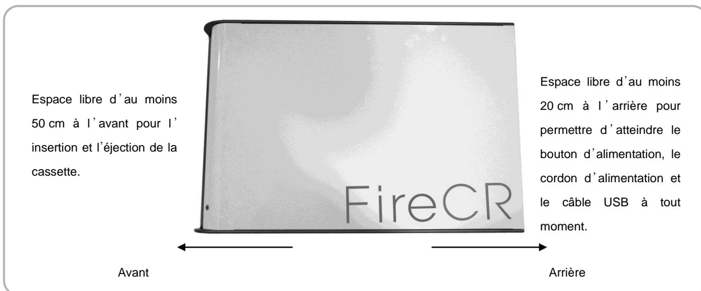
**Figure 4.** Exigences en matière d'espace lors d'une installation sur une table (vue du dessus)
