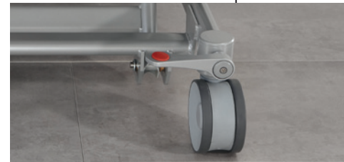
Position horizontale des deux leviers à pédale : toutes les roulettes sont mobiles.
