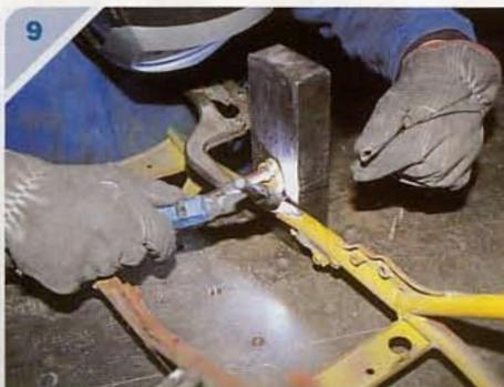
**1** Préalable indispensable à toute opération de soudure, il est impératif de se protéger le corps et yeux. Dans tous les cas, portez des vêtements en coton, des gants ignifugés et des chaussures fermées. Pour les yeux, un masque de soudage est indispensable pour la soudure à l'arc ou le Tig. Pour la soudure au chalumeau, une paire de lunettes de soudeur suffit. Le "plus" est un tablier de soudeur en cuir.
