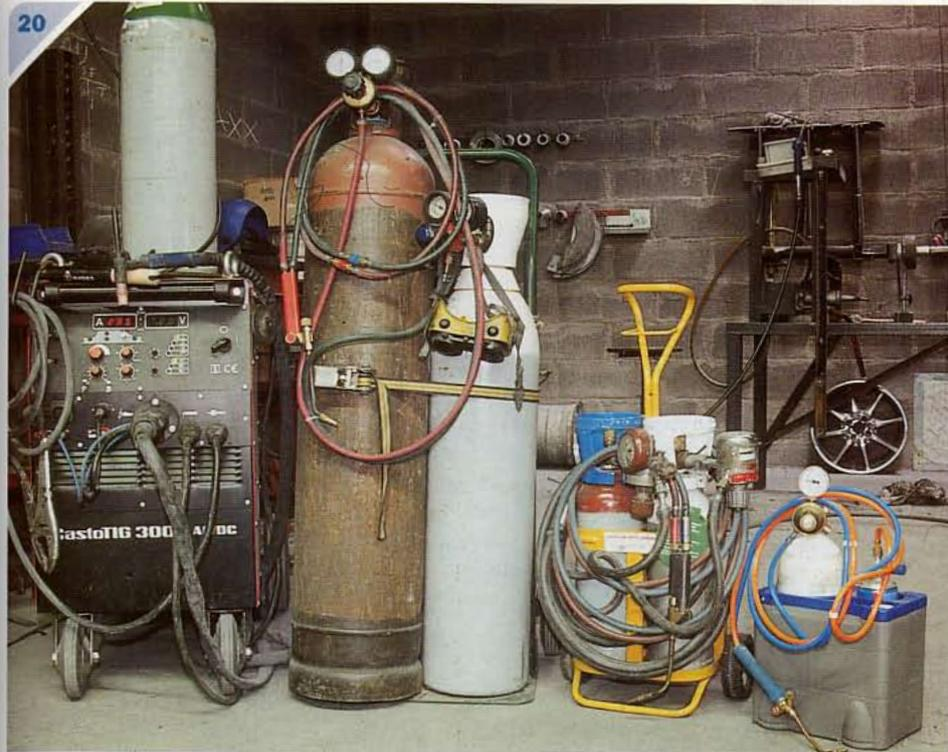
**20** Au diable l'électricité, voici la plus noble des soudures, celle au chalumeau. Là, la chaleur (jusqu'à 3 000 degrés) est produite par la combustion d'un mélange gazeux (généralement du butane ou de l'acétylène associé à de l'oxygène). Il existe une grande variété de postes à chalumeau dans le commerce, depuis le tout petit "oxy-butane" à recharges perdues à 75 euros jusqu'au poste professionnel oxy-acétylène avec de grosses bouteilles rechargeables à plusieurs milliers d'euros.
