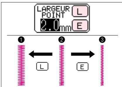
Appuyez sur la touche **REGLAGE POINT** et utilisez ensuite les touches **LARGEUR POINT** **[L]** et **[E]** pour régler la largeur du point d'arrêt.
