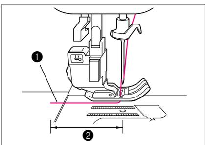
7. Faites passer le fil sous le pied presseur et tirez environ 5,0 cm du fil supérieur vers l'arrière de la machine.
