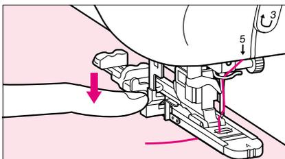
4. Abaissez le levier pour boutonnière de façon à ce qu'il soit positionné derrière le crochet métallique du pied pour boutonnière.
