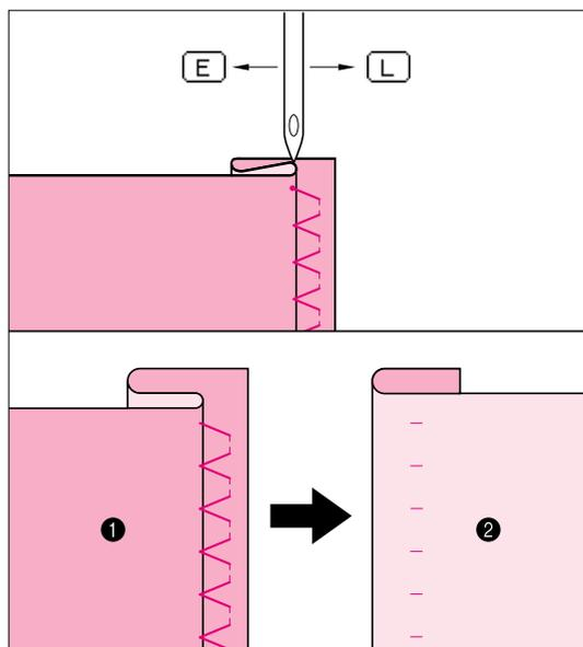
Appuyez sur la touche **REGLAGE POINT** et utilisez ensuite les touches **LARGEUR POINT** **L** et **E** pour régler la position de l'aiguille, de façon à ce qu'elle prenne légèrement le pli de l'ourlet.
