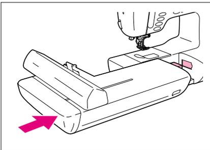
3. Insérez fermement le connecteur de l'unité de broderie dans la prise de connexion.
