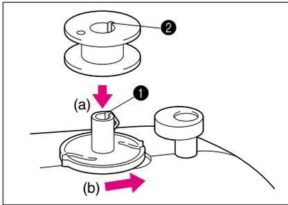
4. Placez la bobine sur l'axe du bobineur de canette, de façon à ce que le ressort de l'axe s'encastre dans la rainure située en haut de la canette (a). Poussez ensuite l'axe du bobineur de canette vers la droite (b).
