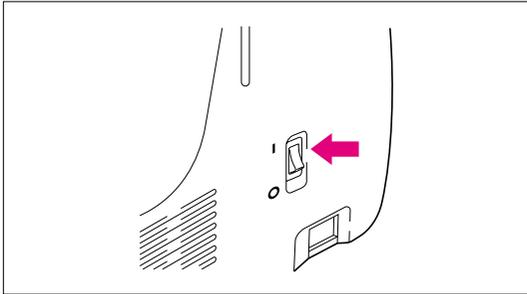
3. Mettez l'interrupteur d'alimentation principale sur "I" afin d'allumer la machine à coudre.
