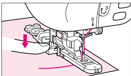
6. Abaissez le levier pour boutonnière de façon à ce qu'il soit positionné derrière le crochet métallique du pied pour boutonnière.
