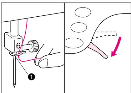
5. Faites passer le fil à travers la boucle métallique et abaissez le levier du pied presseur.
