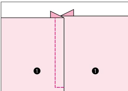
8. Veillez à ce que la patte d'ouverture de la fermeture ne soit pas sur le parcours de l'aiguille et continuez à coudre jusqu'au bord du tissu.
