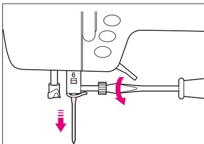
A l'achat de la machine, une aiguille 75/11 est préinstallée sur celle-ci.
