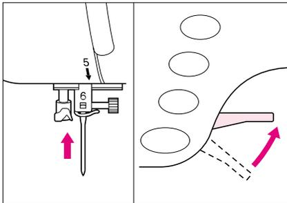
1. **Si le fil supérieur casse** : Arrêtez la machine à coudre, relevez l'aiguille et le pied presseur, et enflez à nouveau le fil supérieur.
