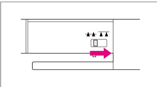
Lorsque le compartiment à accessoires est retiré, le bouton de réglage des griffes d'entraînement est visible à la base de la machine à coudre. Pour abaisser les griffes d'entraînement (par exemple, lorsque vous cousez des boutons), faites glisser le levier vers la droite. Pour continuer à coudre pendant que les griffes d'entraînement font avancer le tissu, faites glisser le levier vers la gauche.
