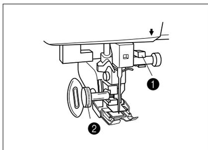
5. Accrochez la fourche de connexion du pied à double entraînement sur la vis de fixation d'aiguille, abaissez le levier du pied presseur et fixez le pied à double entraînement fermement avec la vis (de fixation du pied presseur) à l'aide du tournevis normal ou en forme de disque fourni avec la machine.
