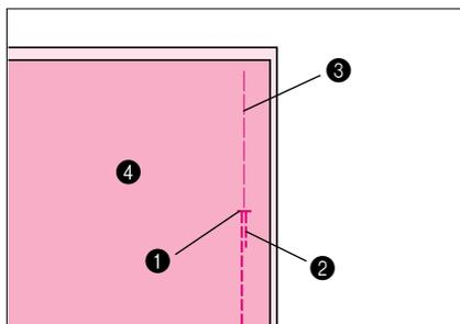
1. Fixez le pied presseur **J**, cousez des points droits jusqu'à l'ouverture de la fermeture à glissière et cousez ensuite des points inverses. Sélectionnez ensuite un point de faufilage et continuez à coudre jusqu'au bord du tissu.
