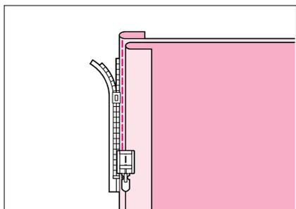
4. Fixez le support du pied presseur à la broche de gauche du pied presseur **I**, ouvrez la fermeture à glissière et cousez ensuite la partie inférieure du tissu à la fermeture, en partant du haut et en allant vers le bas.
