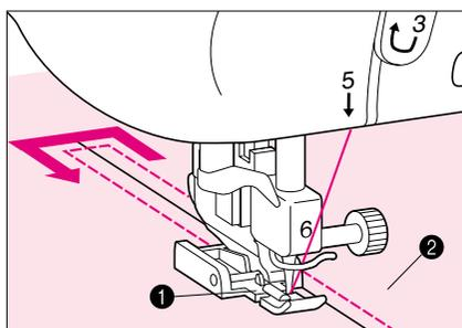
4. Fixez le support du pied presseur sur la broche de droite du pied presseur **I** et cousez autour de la fermeture à 1,0 cm du bord du côté pressé.
