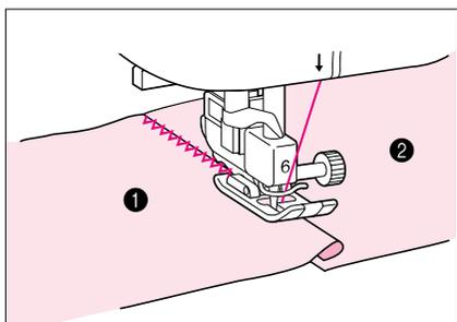
Pliez le bord du tissu supérieur à la largeur souhaitée et posez-le sur le tissu inférieur. Cousez ensuite le point zigzag, de façon à ce que le point réunisse les deux morceaux de tissu.
