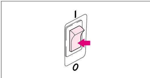
1. Mettez l'interrupteur d'alimentation principale sur "0" afin de mettre la machine hors tension.
