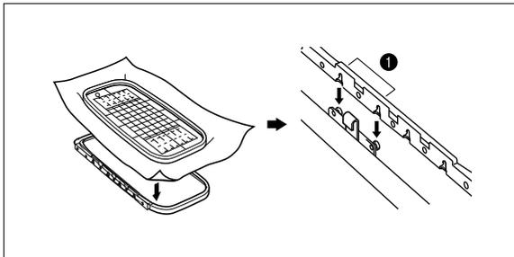
3. Etirez le tissu entre les cadres de broderie intérieurs et extérieurs en veillant à ce que les lignes de référence de la feuille de broderie restent alignées avec celles du motif dessiné sur le tissu. Fixez ensuite le cadre sur le bras de broderie sur la position d'installation supérieure. (Pour plus de détails sur l'installation du cadre de broderie, voir pages 90 - 92.)
