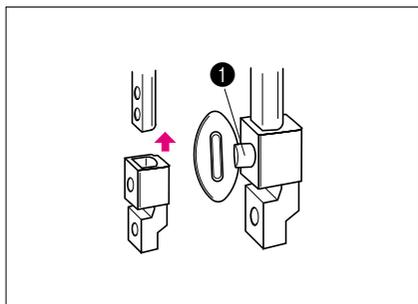
4. Faites glisser l'adaptateur de pied presseur aussi haut que possible le long de la barre du pied presseur et fixez-le fermement avec la vis (de fixation d'adaptateur) à l'aide du tournevis normal ou en forme de disque fourni avec la machine.
