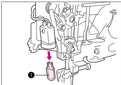
4. Remplacez l'ampoule d'éclairage à agrafe par un modèle neuf du même type.
