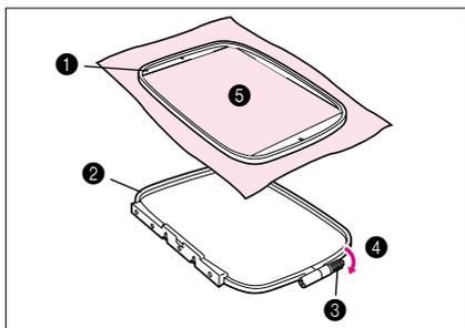
2. Desserrez la vis du cadre extérieur et séparez le cadre intérieur et extérieur. Placez le tissu par-dessus le cadre extérieur, l'endroit du tissu tourné vers le haut, et placez ensuite le cadre intérieur à l'intérieur du cadre extérieur, afin de fixer fermement le tissu.
