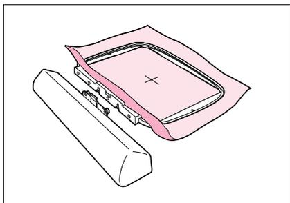
1. Relevez au maximum le levier du pied presseur et faites passer le cadre de broderie sous le pied en veillant à ce que le crochet de fixation du cadre soit placé à gauche et à ce que l'endroit du tissu soit tourné vers le haut.
