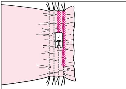
1. Arrêtez la machine avec l'aiguille positionnée à l'extérieur de l'appliqué.
