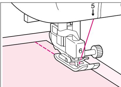
Lorsque le pied presseur fait angle à l'approche d'une couture épaisse, laissez l'aiguille dans le tissu et soulevez le levier du pied presseur. Après avoir égalisé la zone en plaçant un morceau de tissu ou de carton plié sous l'arrière du pied presseur, abaissez le levier du pied presseur et continuez à coudre.
