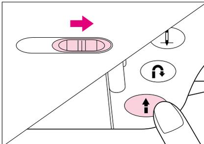
6. Faites glisser le levier de contrôle de la vitesse de couture sur la position maximum (à fond vers la droite).
