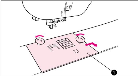
2. Desserrez les vis à l'aide du tournevis normal ou en forme de disque fourni avec la machine.
