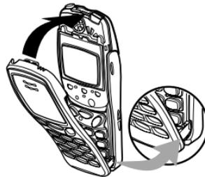
**Remplacer le couvercle arrière :** insérez les quatre taquets du couvercle arrière dans les emplacements correspondants du téléphone et appuyez sur le couvercle jusqu'à qu'il soit enclenché.
