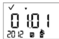
Écran de date d'étalonnage (date du dernier étalonnage affichée ci-dessus)
