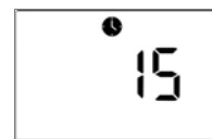
Écran de compte à rebours Pour le personnel agréé uniquement : Lors du compte à rebours de 15 secondes, appuyer sur les deux boutons et les maintenir enfoncés pendant trois secondes pour entrer dans le mode de configuration (voir la section « Configuration »).
