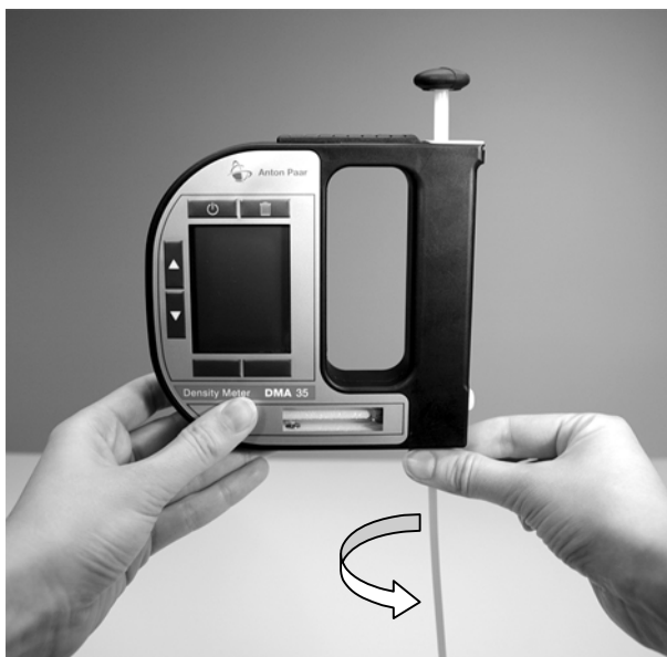
Fig. 7 - 1 Branchement du tube de remplissage
