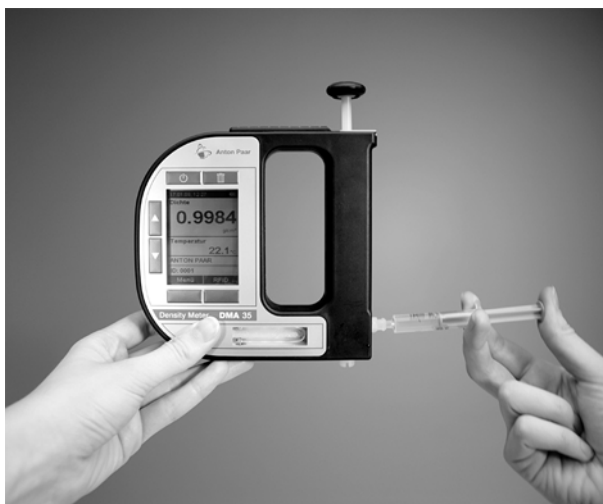
Fig. 9 - 2 Remplissage de la cellule de mesure avec la seringue en plastique
