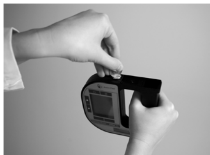
Fig. 11 - 4 Ouverture du couvercle du compartiment à piles
