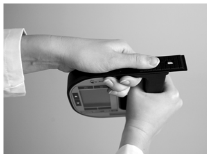
Fig. 11 - 3 Retrait du verrouillage de la pompe
