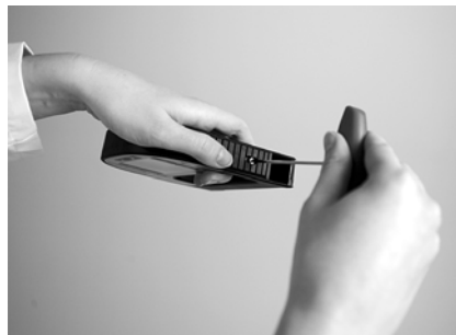
Fig. 11 - 2 Retrait de la vis de verrouillage de la pompe
