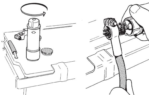
Nettoyage des bornes de batterie
