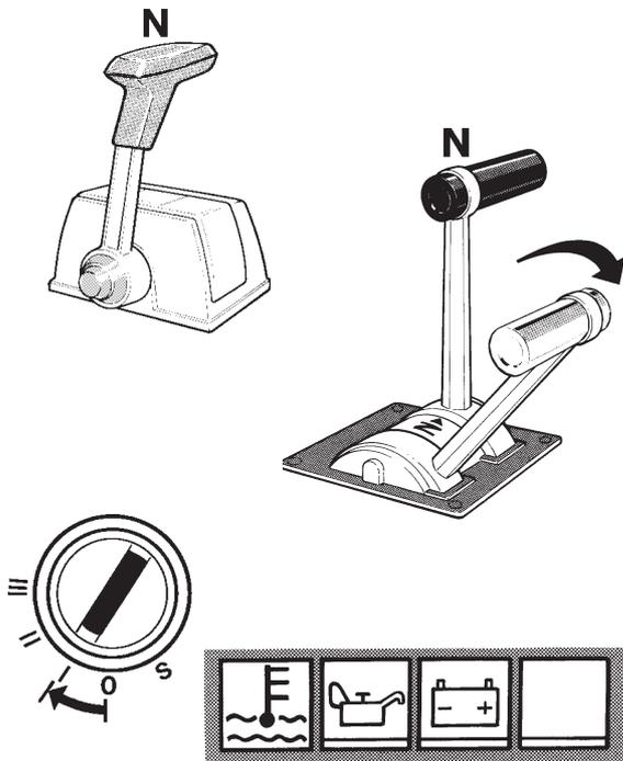
1. **Commande monolevier :** Vérifiez que le levier est au point mort, position neutre « N ». La commande d'accélérateur est alors en position de ralenti et l'inverseur est au point mort.
