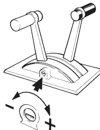
Réglage du frein de friction sur les commandes à deux leviers
