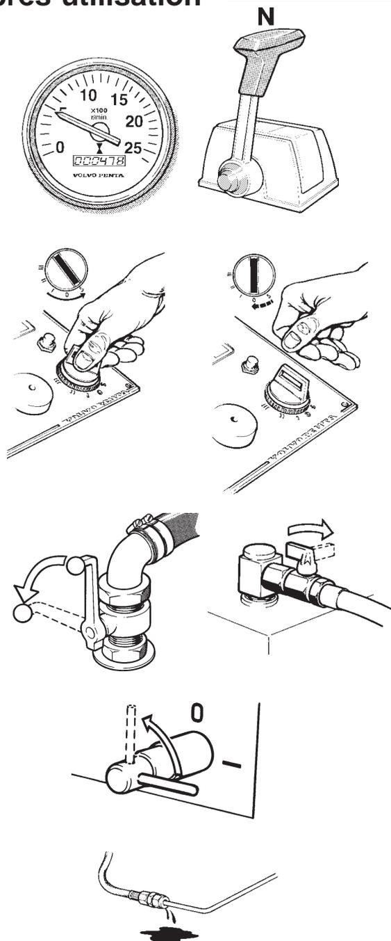
1. Laissez le moteur tourner au ralenti durant quelques minutes, avec l'inverseur au point mort, après l'accostage. Ceci permet de régulariser la température du moteur et d'éviter les surchauffes locales qui pourraient provoquer l'ébullition du réfrigérant.
