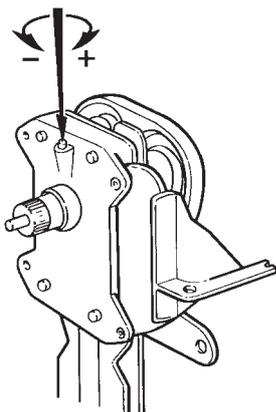
Réglage du frein de friction sur les commandes monolevier (Simple ou double)
