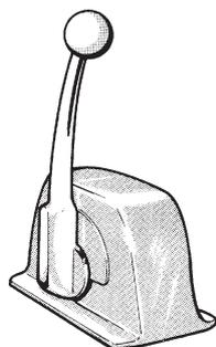
Commandes de type S pour les manoeuvres de la vanne de glissement
