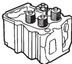
Culasses individuelles, une tête par cylindre. Celles-ci sont interchangeables et vissées en place à l'aide de 6 boulons.
