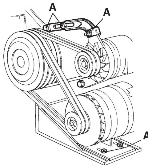
Tension des courroies d'entraînement
