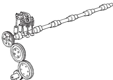
L'arbre à cames à sept palies est entraîné par pignons et situé en position haute.
