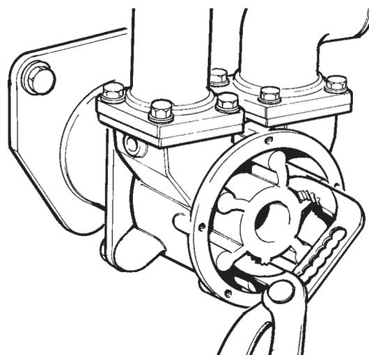
Dépose de la roue à aubes dans la pompe à eau de mer
