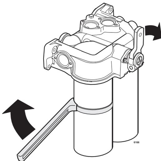
Remplacement des filtres à huile commutables lorsque le moteur tourne
