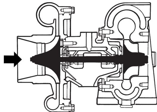
Arbre de rotor du turbocompresseur
