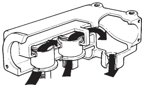
Débit de réfrigérant moteur pendant que le moteur est froid
