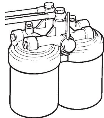
Filtres fins à carburant à remplacer pendant que le moteur tourne
