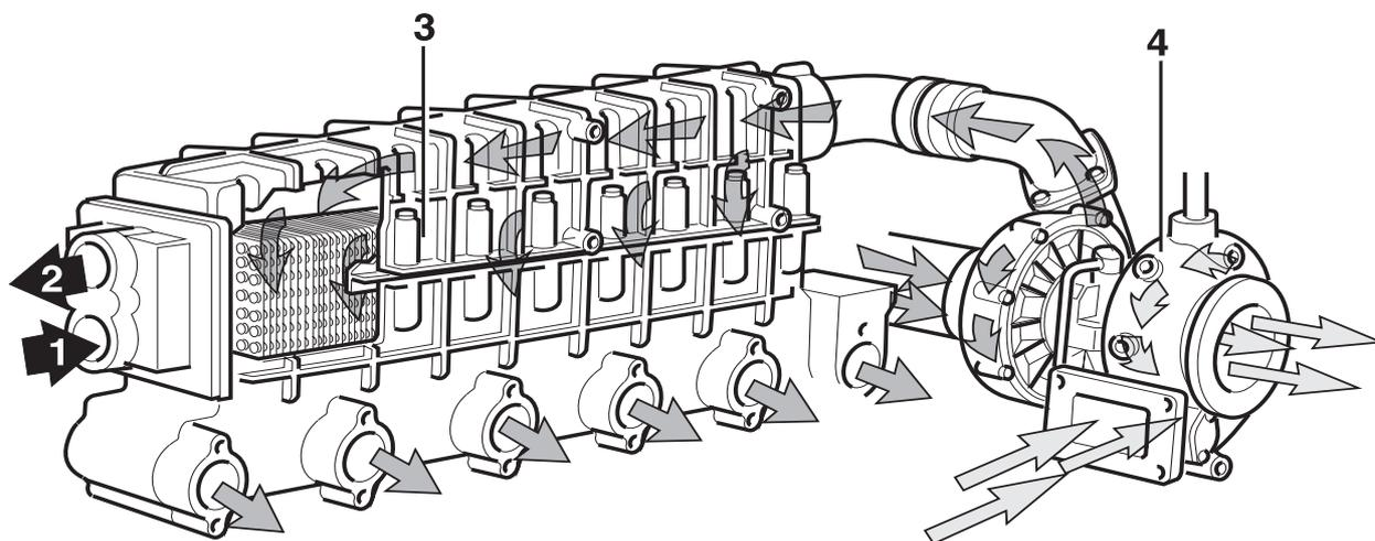
Turbocompresseur et refroidisseur d'air de suralimentation
