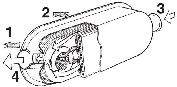
1. Huile chaude provenant du système de graissage du moteur
