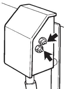
Boîtier de connexions électroniques avec fusibles semi-automatiques
