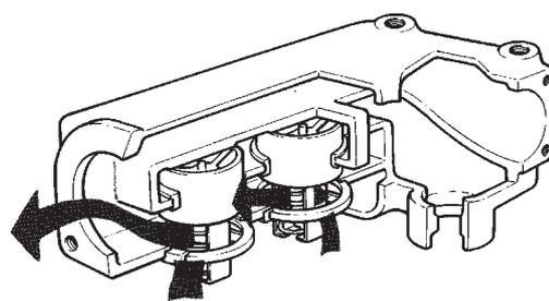
Débit de réfrigérant moteur pendant que le moteur est à sa température de service normale
