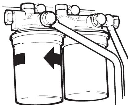
Remplacement des filtres à carburant fins
