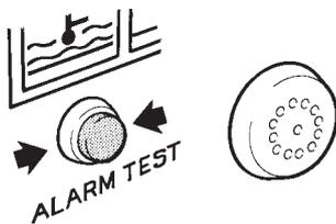
3. Appuyez sur le bouton de contrôle d'alarme « Alarm test » et vérifiez que l'alarme se déclenche (les témoins d'avertissement s'allument). L'alarme s'arrête lorsque le bouton est relâché.
