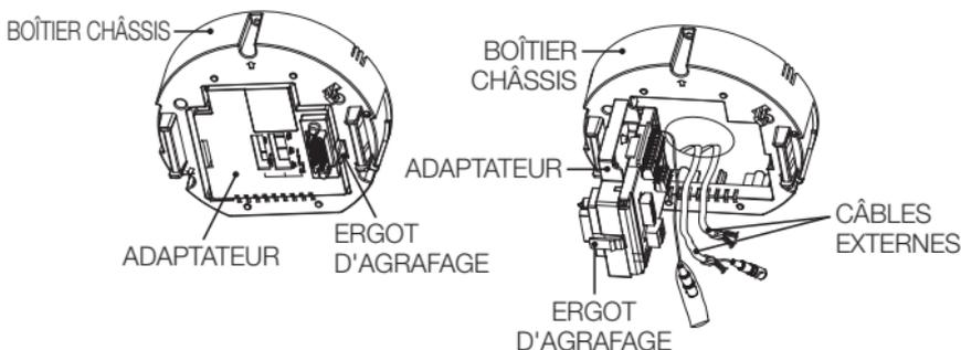
2. Utilisez les trois « VIS » pour fixer le « **BOÎTIER CHÂSSIS** » sur la position d'installation « **CAMÉRA** ».
