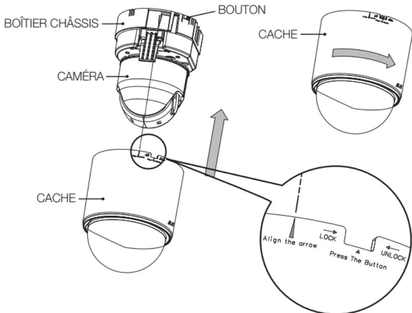
Si vous souhaitez retirer le « **CACHE** », maintenez le « **BOUTON** » enfoncé et tournez le « **CACHE** » dans le sens inverse des aiguilles d'une montre afin de retirer le « **CACHE** ».
