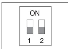
Comme montré dans la carte de structure, lorsque les Contrôleurs RS-422A/RS-485 sont connectés, il doit être connecté en sortie selon les caractéristiques d'impédance du Câble sur chaque extrémité de la ligne d'émission pour transférer les signaux sur de longues distances en réglant la réflexion des signaux au plus bas.
