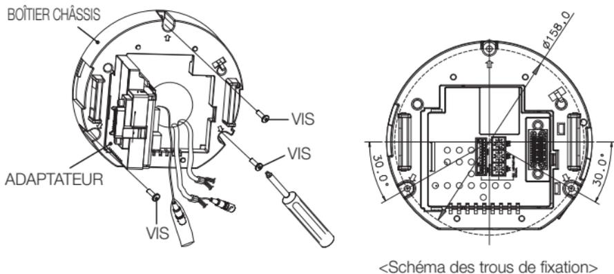
3. Connectez les câbles externes aux « **CONNECTEURS (ALARM IN, ALIMENTATION, RS-485, ALARM OUT)** » et le « **CONNECTEUR** » à l'« **ADAPTATEUR** ».
