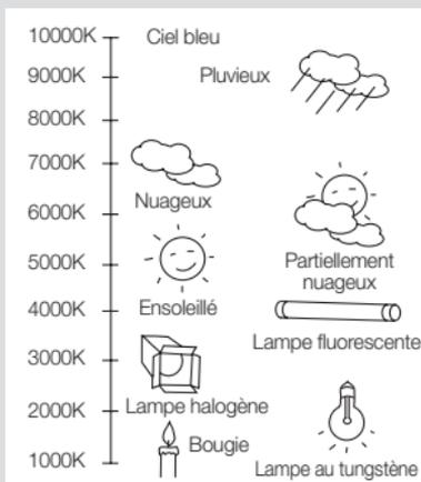
※1 : En activant le mode <BA1> dans un environnement de température de couleur variant entre 2500 K et 9300 K, il se peut qu'il soit impossible de produire une valeur de balance des blancs appropriée ; dans ce cas, il est conseillé d'utiliser le mode <BA2>.
