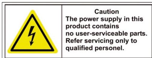
**Risque lié à l'alimentation électrique :** Le bloc d'alimentation est branché sur le secteur. L'appareil doit être branché à une alimentation électrique à la tension nominale et au courant conformes, homologuée UL, et enfermée dans un boîtier de protection adéquat. Le bloc d'alimentation ne contient aucune pièce pouvant être réparée par l'utilisateur.
