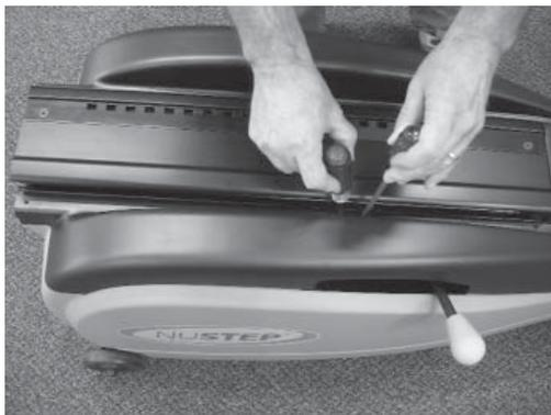
Pour l'installation du couvercle avant, placez la pointe à tracer dans le troisième trou à partir de l'avant pour aligner les trous et insérez ensuite les trois vis. Répétez cette étape de l'autre côté.
