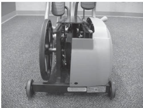
Accrochez les couvercles latéraux sur le support situé juste en dessous du rail du siège.
