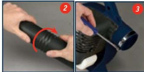
2. Placez l'anneau de fixation autour de la sortie d'air du carter du souffleur (3). Ne serrez pas encore la vis
