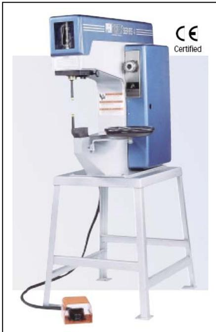
Une presse pneumatique de marque PEMSERTER va être installée dans le secteur de la production. Cette presse permet d'emboutissage d'insert. Le document fourni par le constructeur est de mauvaise qualité (traduction incertaine et schéma pneumatique non normalisé). On désire étudier l'ensemble du dossier pour permettre une meilleure compréhension et d'effectuer les modifications nécessaires.
