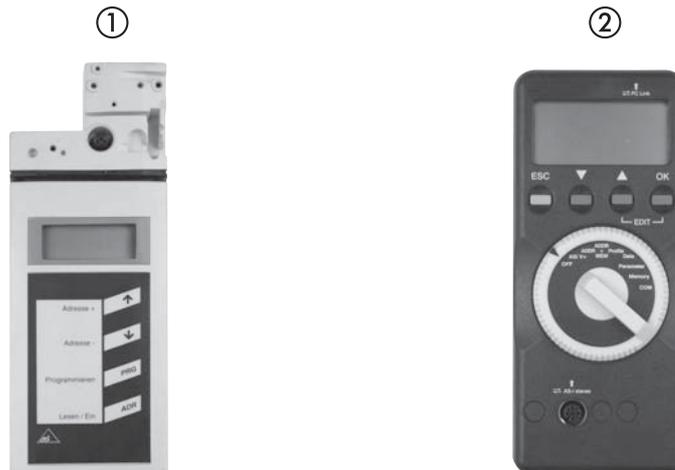
Les deux peuvent être utilisés pour l'adressage des modules en les connectant avec le câble MW cod. 0226950150 au connecteur M12. Il est aussi possible de procéder à l'adressage à partir du Maître, si il le permet. Pour la procédure, se référer aux instructions du Maître qui est utilisé.
