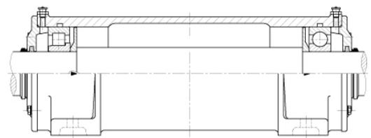
version avec roulement à rouleaux cylindriques /
