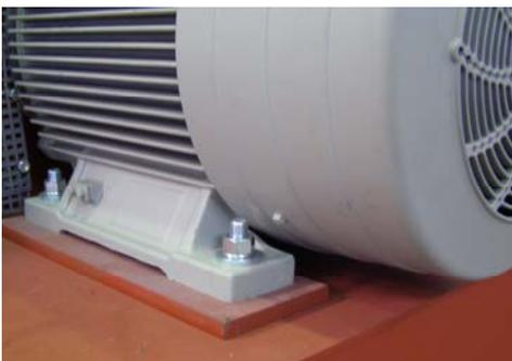
**Vue 8** : Exemple d'une fixation boulonnée de moteur
