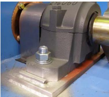
**Vue 7** : Exemple d'une fixation boulonnée de palier
