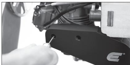
1. Placez une rondelle frein sur chaque vis de fixation du silencieux. Glissez les vis au travers du silencieux.
