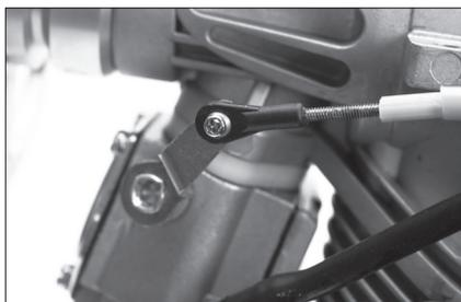
1. Utiliser une méthode sûre pour fixer la tringlerie des gaz au palonnier des gaz du carburateur.
