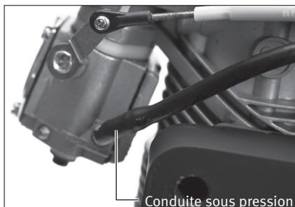
1. Reliez la prise d'alimentation du carburateur à la sortie du réservoir en utilisant de la durite FKM de grand diamètre.
