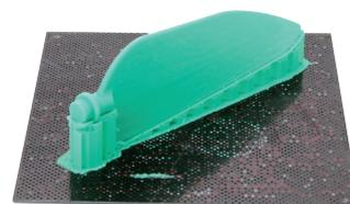
Pièces nettoyées à côté des débris du support d'impression.
