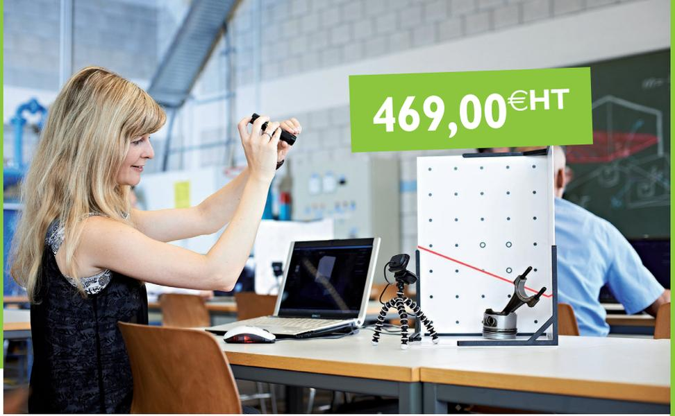
Ce scanner permet d'obtenir un fichier numérique 3D au format STL de la pièce scannée et de pouvoir utiliser ce fichier avec une imprimante 3D pour reproduire l'objet éventuellement à une échelle différente. La numérisation se fait avec une caméra raccordée à un ordinateur; le scannage se fait manuellement à l'aide d'un laser à mains en balayant les surfaces de la pièce.
